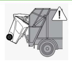
Asegúrese que los sistemas de elevación de los carros recolectores estén calibrados ya que movimientos excesivos o muy rápidos pueden causar daños en el contenedor.
