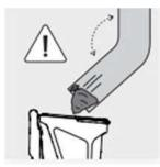
Si se usa en shut de basuras, este debe contar con inclinación al final para reducir la velocidad de las basuras
